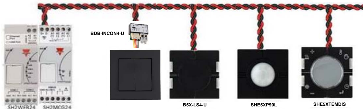
Figur 2 Viktigt att man har rätt polaritet genom hela slingan (D+ D-)
